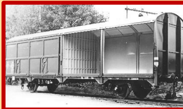
Bij Werkspoor ontwikkelde men de schuifwandwagens: hier kon de vorkheftruck de pallets zo naar binnen schuiven.
